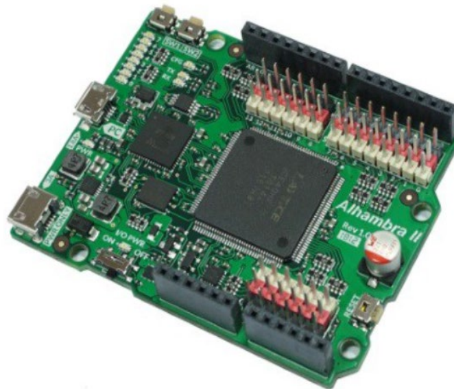
Figura 4.8 FPGA alhambra II esta fpga es open source y se ha ido innovando de manera acelerada en su programación haciéndola cada vez más amigable.
