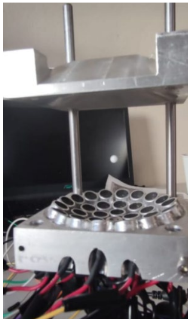
Figura 3.15 levitador cóncavo con reflector de aluminio levitando una esfera de poliestireno.
