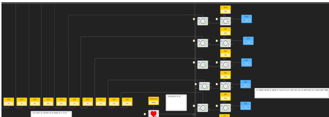
Figura 3.17 Esquema de programación de la fpga alhambra II cada bloque se encuentra programado en verilog.
