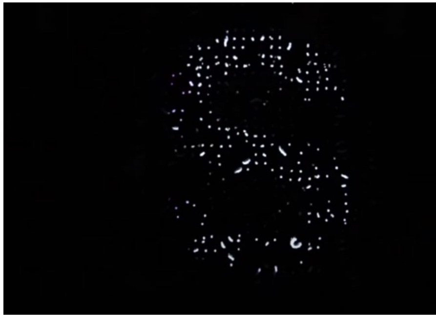
Figura 4.2 poliestireno levitado e iluminado generando una holografía acústica de forma de s. Inoue es un investigador con diversas publicaciones acerca de la levitación acústica y el desarrollo del levitador mostrado en la figura 4.3
